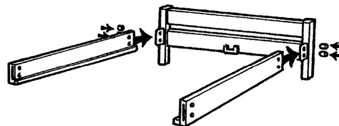
2. So verbinden Sie dann die Fußwange mit den Seitenwangen: Beide Seitenwangen gleichzeitig anheben und genau wie beim Betthaupt mit der Fußwange verbinden.
