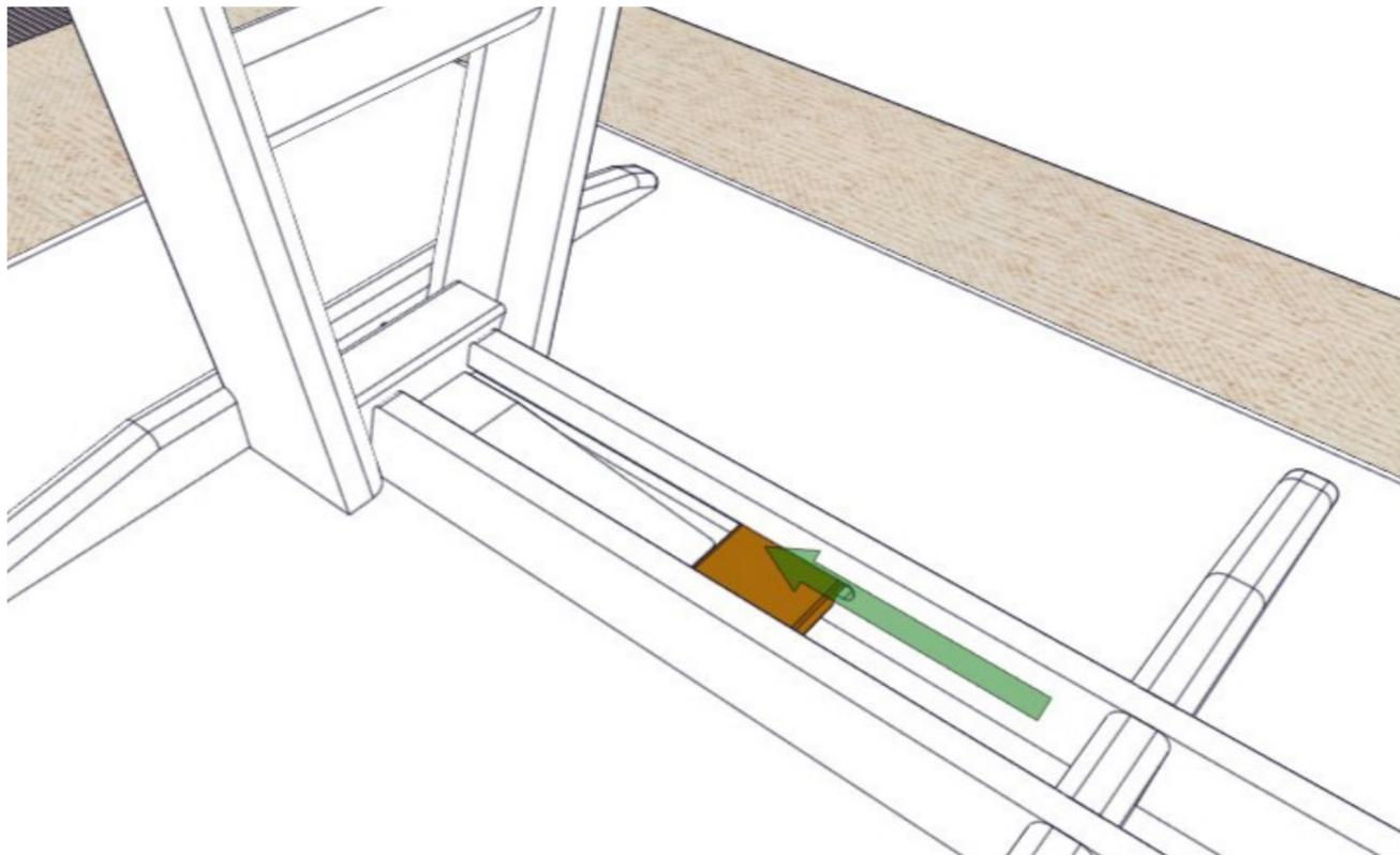
5. Dübel durch die Bohrungen in der Gratleiste stecken und das Fußgestell sichern.
