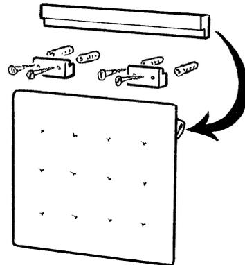
2. Die Zeichnung zeigt Ihnen die richtige Position der kurzen Holzleisten. Achten Sie beim Anzeichnen auf die gleiche Höhe der rechten und linken Leiste. Wandlöcher bohren, Dübel einstecken und die kurzen Leisten anschrauben.
