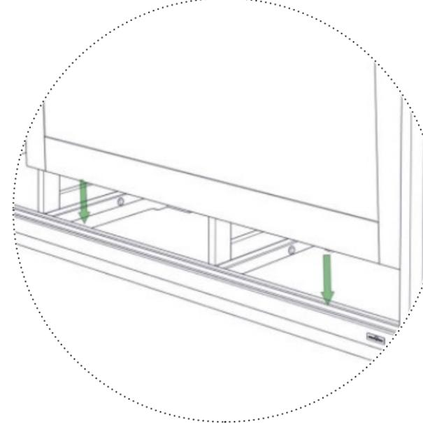
10. Erste Tür schräg anheben und die Laufrädchen unten in die **hintere** Führungsrille einsetzen.
