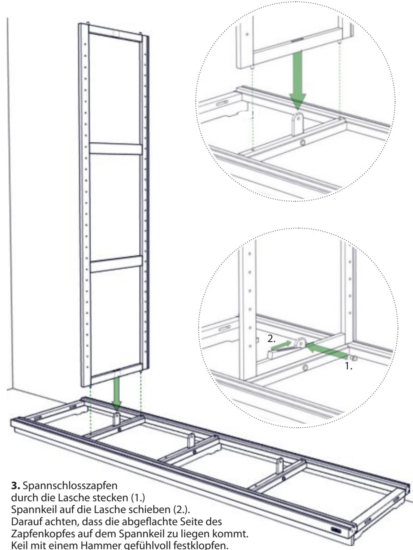
**3.** Spannschlosszapfen durch die Lasche stecken (1.) Spannkeil auf die Lasche schieben (2.). Darauf achten, dass die abgeflachte Seite des Zapfenkopfes auf dem Spannkeil zu liegen kommt. Keil mit einem Hammer gefühlvoll festklopfen.
