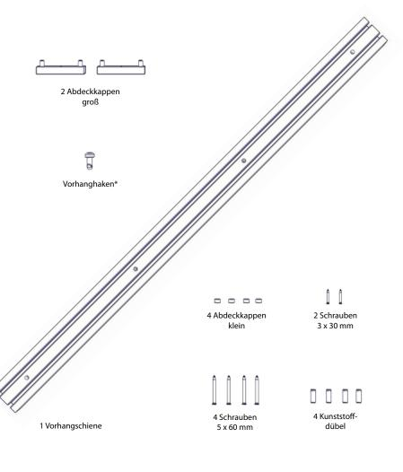
**1.** Listello eckig wird – ohne Halterungen – an die Decke montiert. Bohrstellen an der Decke markieren, Löcher bohren, Kunststoffdübel in die Bohrung stecken, Schrauben (5 x 60 mm) eindrehen.
