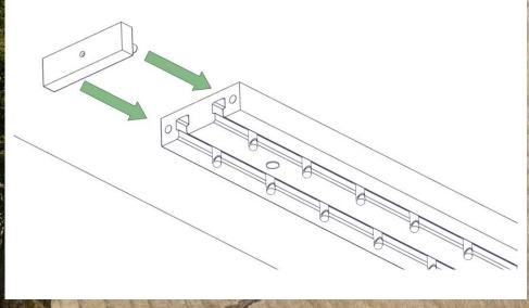
5. Abdeckkappen mit Schrauben 3 x 30 mm an der Vorhangschiene fixieren.
