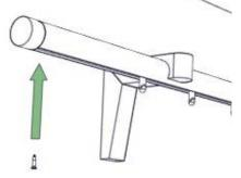
**9.** Bei Vorhängen mit Schlaufen: Laufrille für die Vorhanghaken nach oben drehen. Vorhangstange mit entsprechend langen Schrauben (nicht im Lieferumfang enthalten) an den Halterungen fixieren, siehe **5.** Dann weiter bei **7.**
