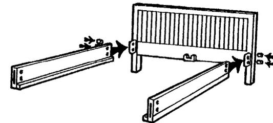
2. So verbinden Sie dann die Fußwange mit den Seitenwangen: Beide Seitenwangen gleichzeitig anheben und genau wie beim Betthaupt mit der Fußwange verbinden.
