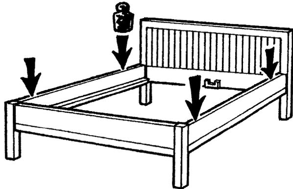
4. (Bei Bettbreiten ab 160 cm:) Stecken Sie die Mittelfüße in den Mittelsteg und legen Sie den Mittelsteg ein. Jetzt können Sie Lattenrost(e) und Matratze(n) auflegen.
