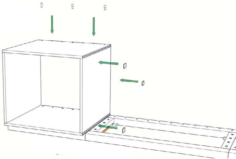
**13.** Zum seitlichen Anbau weiterer Module die Montageleisten wie oben beschrieben an der Wand befestigen.
