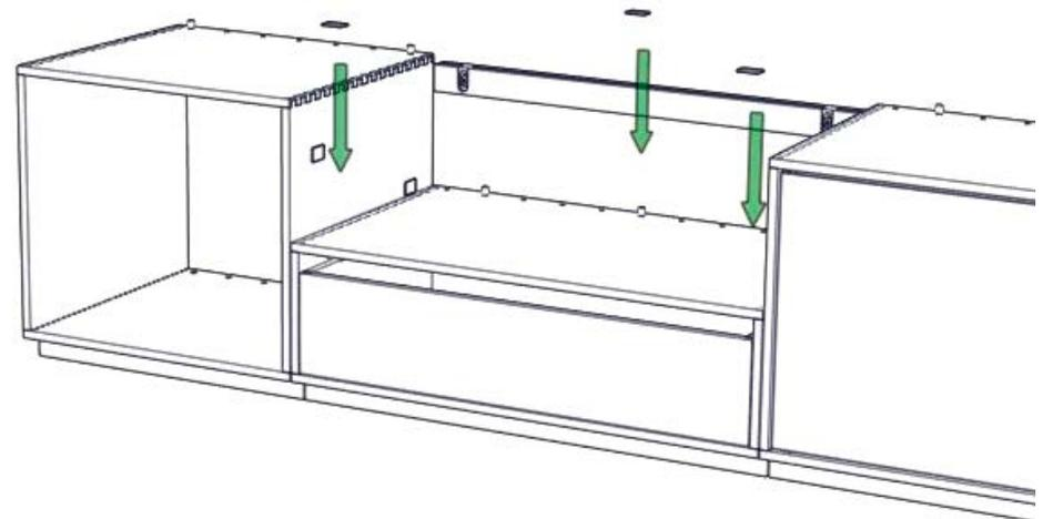
**16.** Oberes Modul (mit 3 seitlich festgeklebten Filzplättchen) auf das untere Modul aufsetzen, und durch Holzdübel  $\varnothing 8 \times 25 \text{ mm}$  mit der Montageleiste verbinden.
