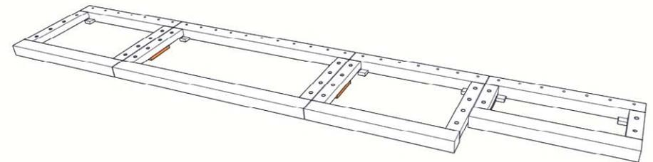
**8.** Mit Hilfe der Schablone\* die Bohrlöcher für die Montageleiste an der Wand markieren. Die Schablone kann sowohl links als auch rechts angeschlagen werden. Bohrer und Dübel je nach Wandmaterial (Holz, Ziegel, Beton etc.) wählen, und die Löcher bohren.
