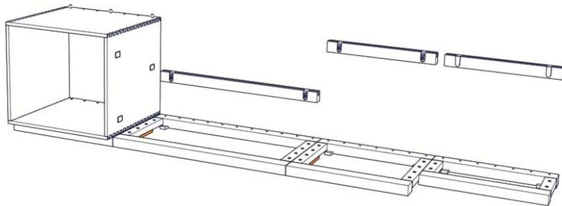
**14.** Alle weiteren Module der untersten Reihe, wie beschrieben, auf die Sockel aufsetzen und mit den Montageleisten durch Holzdübel **Ø 8 x 25 mm** verbinden. Bei allen Modulen, auf die ein weiteres Modul aufgesetzt werden soll, Holzdübel **8/10 mm** oben in die Bohrungen stecken.
