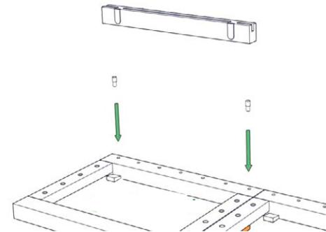
**11.** Modul auf den Sockel aufsetzen. Dann zwei Holzdübel Ø 8 x 25 mm durch die Bohrungen oben am Modul in die Nut der Montageleiste stecken. So ist das Modul fest mit dem Sockel und der Montageleiste verbunden.
