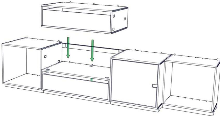
**17.** Nun ist die unterste Reihe des Modulsystems fertig. Bei allen Modulen, auf die ein weiteres Modul aufgesetzt werden soll, Holzdübel  $8/10 \text{ mm}$  oben in die Bohrungen stecken. Und: 3 Filzplättchen auf der Oberseite ankleben, wie unter **15.** beschrieben.
