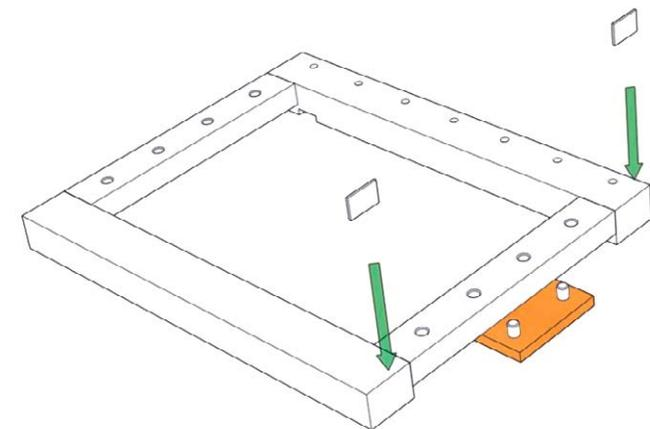
4. Die beiden Sockel mittels Verbindungsplatte zusammenfügen.
