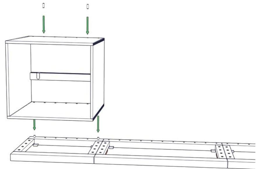
**12.** Zum Weiterbauen des Modulsystems nach oben bzw. zur Seite hin: 3 Holzdübel **8/10 mm** in die Bohrungen an der Oberseite des montierten Moduls stecken. 3 Filzplättchen auf der Seite des Moduls ankleben: ein Plättchen ca. 3 cm von der Wand entfernt, zwei Plättchen ca. 3 cm von der Vorderkante entfernt (eines oben, eines unten).
