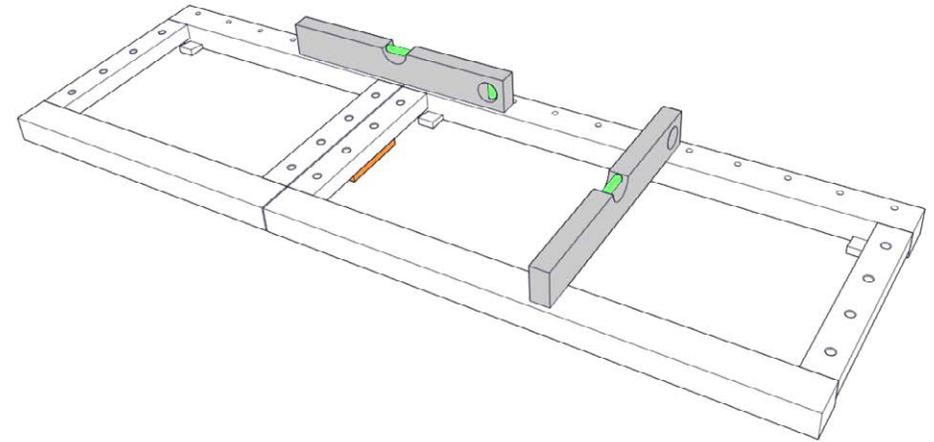
7. Alle weiteren Sockel auf die gleiche Weise wie die beiden ersten miteinander verbinden, nicht auf die Keile vergessen. Sobald ein neuer Sockel mit den anderen verbunden ist, mit der Wasserwaage prüfen.
