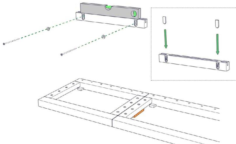
**10.** Zwei Holzdübel 8/10 mm in die wandseitigen Bohrungen des Sockels stecken (bei breiteren Modulen mehrere Dübel verwenden).
