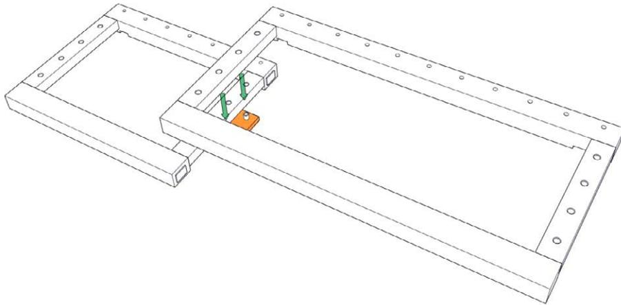
5. Wasserwaage anlegen. Zum Ausgleich von Bodenunebenheiten Keile (4 Stk. pro Sockel) in die Ausnehmungen an der Unterseite der Sockel einsetzen. Keile so weit hineinschieben, bis die Sockel waagrecht liegen.
