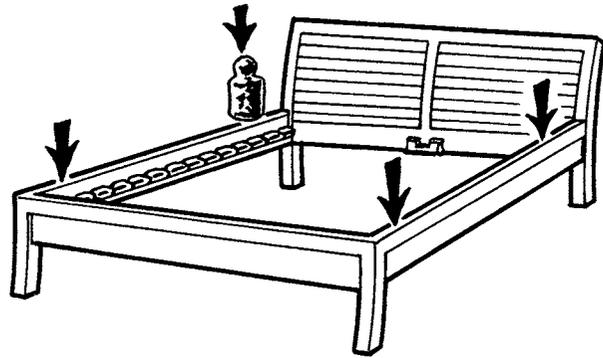
**3.** Sobald Ihr Bett am vorgesehenen Platz steht, drücken Sie mit viel Gewicht die Seitenwangen an den Eckverbindungen nach unten. (Dadurch werden die Teile stabil zusammengepresst. Danach sollten Sie das Bett nur noch am Kopf- oder Fußteil anheben!)
