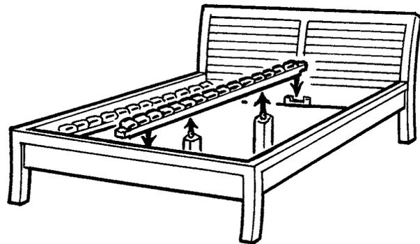
**4.** (Bei Bettbreiten ab 160 cm): Stecken Sie die Mittelfüße in den Mittelsteg und legen Sie den Mittelsteg ein.
