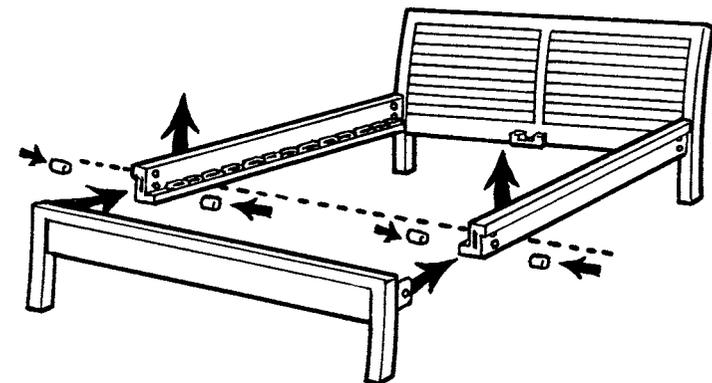
2. So verbinden Sie dann die Fußwange mit den Seitenwangen: Beide Seitenwangen gleichzeitig anheben und genau wie beim Kopfhaupt mit der Fußwange verbinden.
