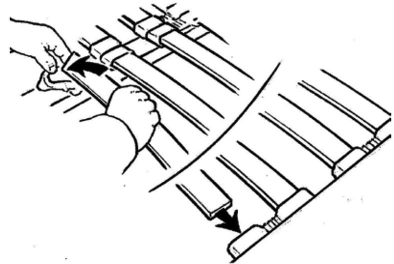
**5.** Einstecken der Federleisten: Alle Federleisten werden zuerst mit einem Ende in ihren Kautschukschuh gesteckt, dann leicht gebogen in den gegenüberliegenden Kautschukschuh.
