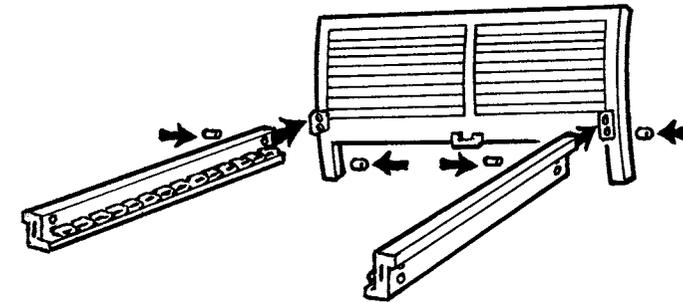
1. Stellen Sie das Kopfhaupt auf und stecken Sie die beiden Seitenwangen in die Laschen des Kopfhaupts ein - mit den Auflageleisten für den Lattenrost nach innen. Heben Sie die Seitenwangen etwas an, sodass Sie die Verbindungsstifte leicht einstecken können.
