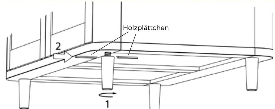
**9.** Schrank an den endgültigen Aufstellplatz stellen. Für eine gleichmäßige Fuge zwischen den Türen den Schrank ins Lot bringen. Dazu den/die entsprechenden Fuß/Füße ein wenig herausdrehen (1). Falls notwendig, zur Entlastung des Holzgewindes pro Fuß 2 Holzplättchen zwischen Bodenplatte und Fuß einklemmen (2). Füße nicht weiter als 8 mm herausdrehen!
