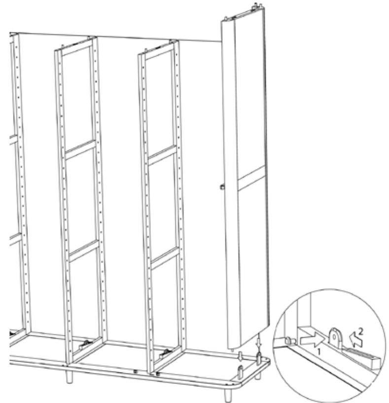
**4.** Die zweite Seitenwand auf die Holzlaschen der Bodenplatte stellen. Holzdübel durch die Lasche stecken (1), Spankeil auf die Lasche stecken (2) und mit einem Hammer gefühlvoll „auf Zug“ festklopfen.
