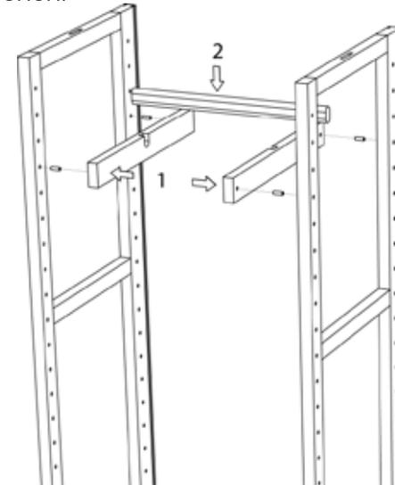
**10.** Montieren der Kleiderstange: Die beiden Halterungen (Ausnehmung nach oben) für die Kleiderstange in gewünschter Höhe mit Fachträgern (Holzstifte) an Seitenwand und Innenrahmen befestigen (1). Kleiderstange einlegen (2).
