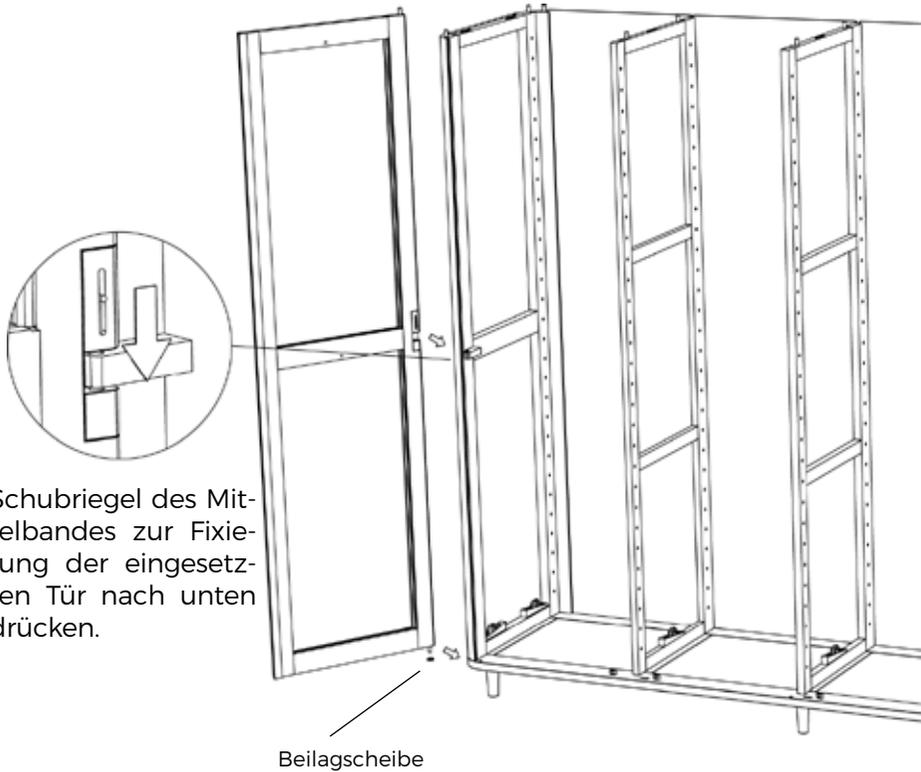
Schubriegel des Mittelbandes zur Fixierung der eingesetzten Tür nach unten drücken.
