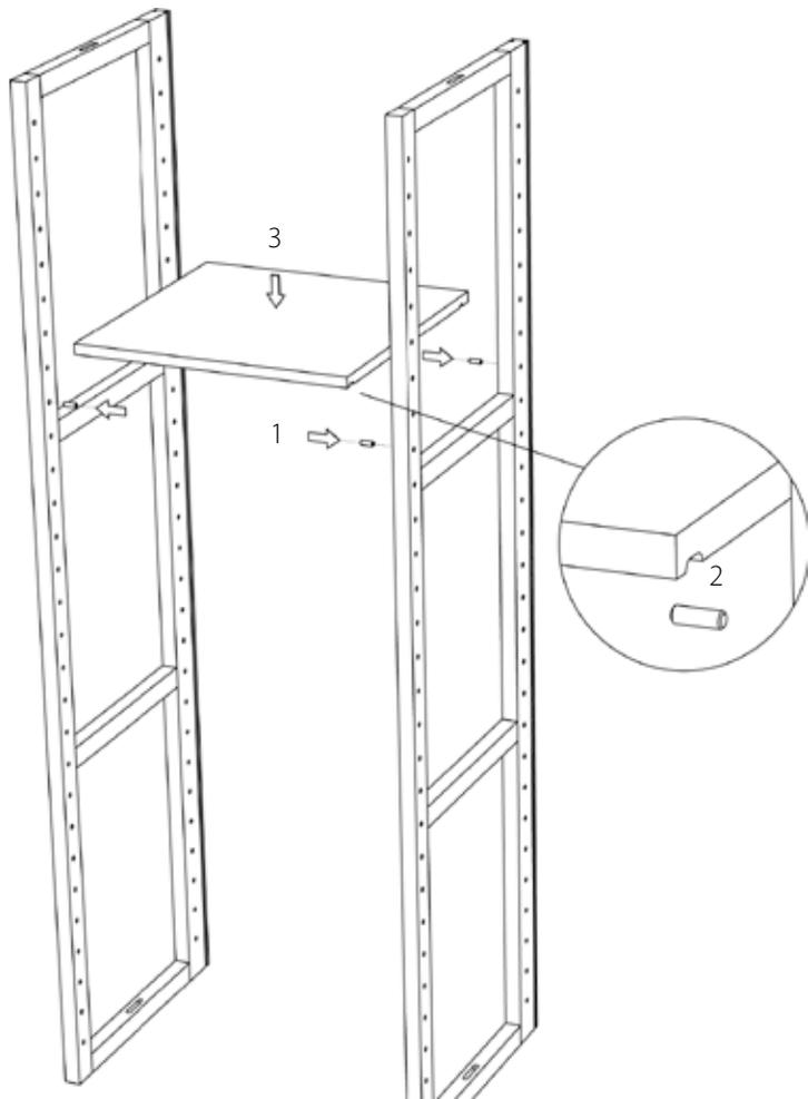
**11.** Pro Fachbrett 4 Fachträger (Holzstifte) in gewünschter Höhe in die Bohrungen der Seitenwand und des Innenrahmes stecken (1). Fachbretter – größere Ausnehmungen vorne (2) – auf die Fachträger legen (3).
