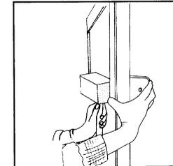
3. Stecken Sie den Unterboden (beide Böden sind identisch) auf die Konsole. (Die Vorderseite hat 2 Nuten)
