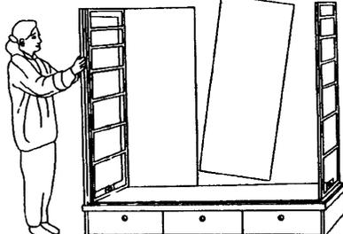
5. Als nächsten Schritt nehmen Sie einen Seitenrahmen und eine Rückwand zur Hand. Zuerst stecken Sie den Seitenrahmen auf und lassen ihn von einem Helfer festhalten. Anschließend wird die Rückwand in den Seitenrahmen und auf den Unterboden gesteckt. Dann die zweite und dritte Rückwand mit der Verbindungsleiste einsetzen. Zuletzt stecken Sie den zweiten Seitenwandrahmen ein. Seiten- und Rückwände halten oder außen mit Klebeband befestigen.
